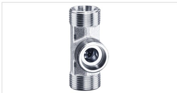
WV - Wechselventile: Ventil mit zwei wechselseitig sperrbaren Zuflüssen und einem Abfluss. Die Zufluss-Seite mit dem höheren Druck ist mit dem Abfluss verbunden. Der andere Zufluss ist dann per innen liegender Kugel gesperrt.
