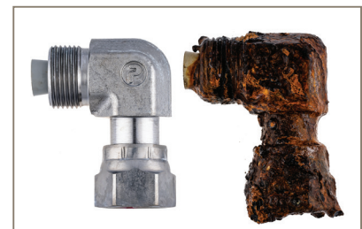
Abbildung 9: ToughShield Plus (links) und verzinkte (rechts) Schwenkadapter nach 3.000 Stunden SST
