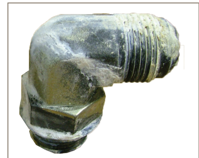
Abbildung 5: Zinkoxidation an einer Stahlrohrverschraubung
